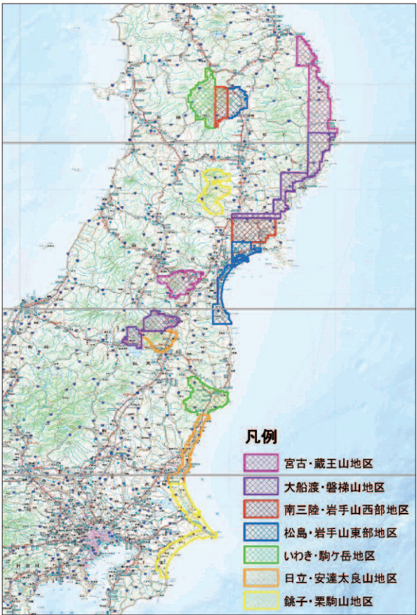
図 5 東北地方太平洋沖地震に伴う航空レーザ計測実施計画
