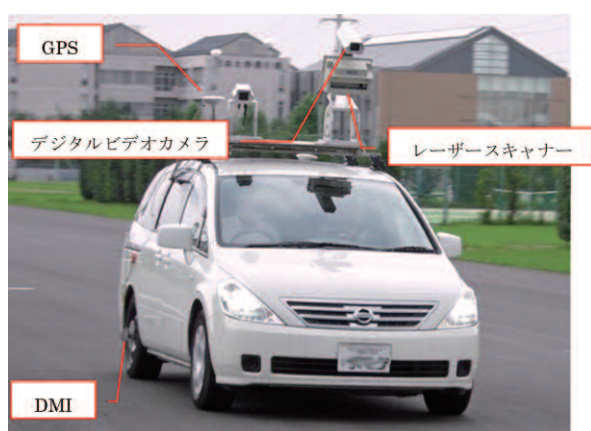
図6 モバイルデータ計測システム（ニコン・トリンブル社）
