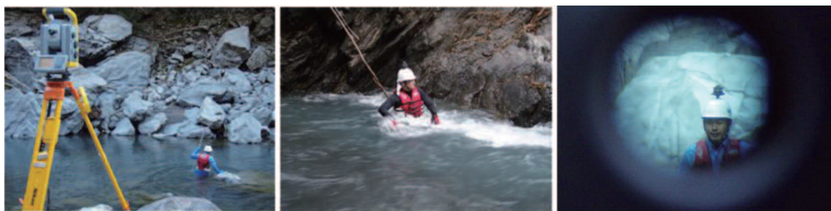
図 6 ミラー帽計測による 3次元データ取得状況
