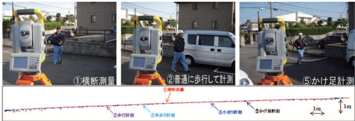
図7 精度検証状況
