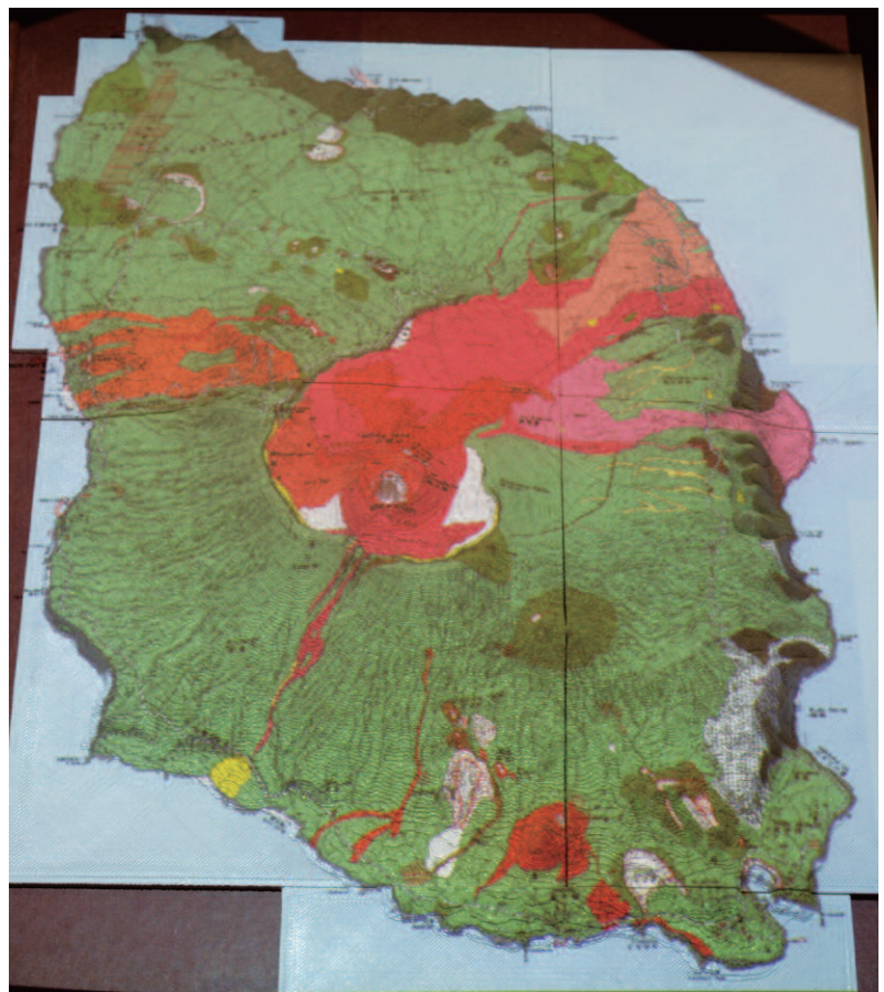
地理院地図3Dのデータを3Dプリンターで出力して作成した伊豆大島の立体模型。2013年10月の台風26号による被害状況などをプロジェクターで投影して表している。
