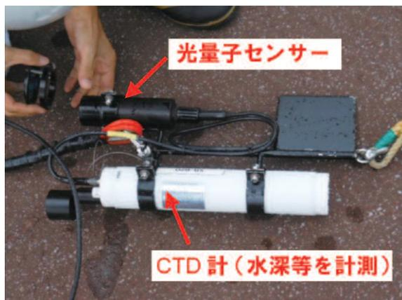
図 3 光量子測定機器
