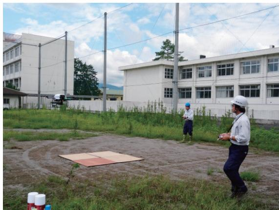
図1 テザーによる飛行制限と離発着場から飛び立つUAV
