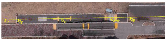
図3 横断測量の計測ポイント
