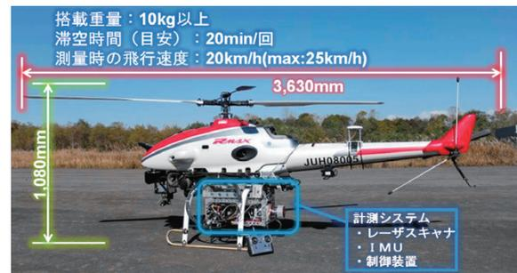
図1 計測システム搭載状況
