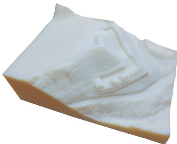
図1 高精細な数値標高データ（陰陽図表現）及び精密地形模型の例（左図は陰陽図による立体表現（瀬戸島・秋山・本田による））
