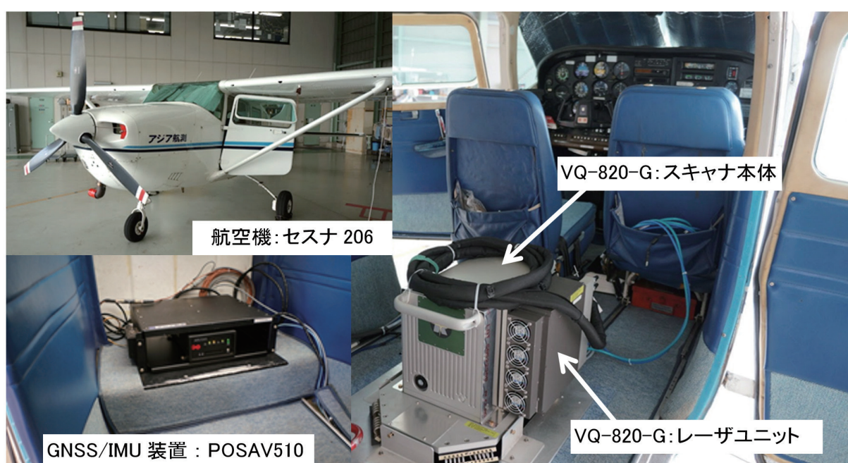
図4 小型航空機(C206)への搭載状況
