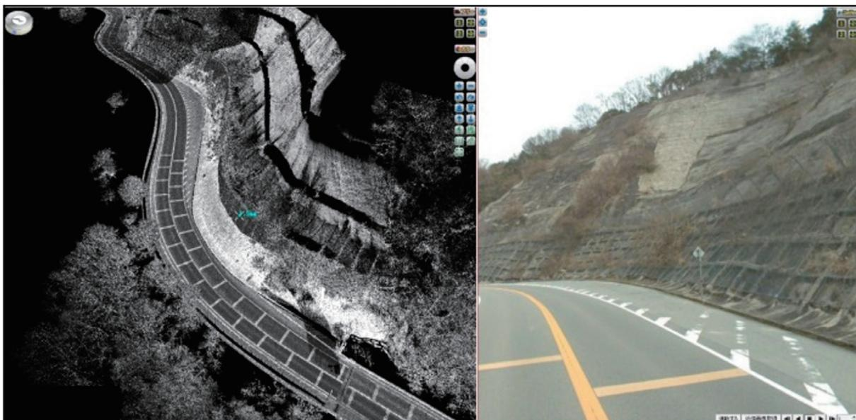
図5 LaserMapViewによる3次元レーザー点群取得状況
