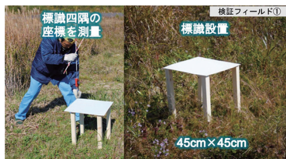
図 14 水平精度検証用対空標識
