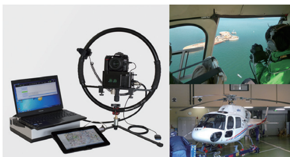
図3 携帯型斜め撮影システム（PALS）と撮影風景
