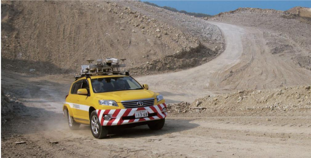
図1 MMS による工事現場の計測
