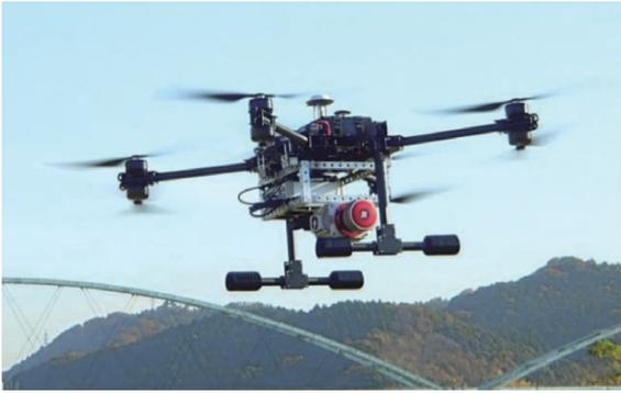
図12 UAVレーザ計測システム「TOKI」
