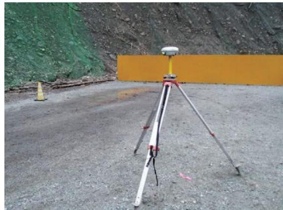
図21 GNSS 測位機
