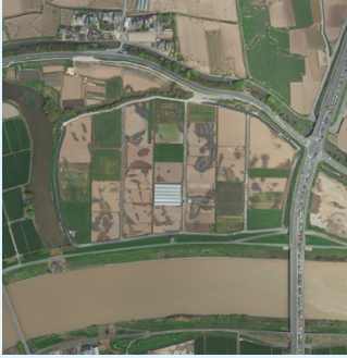
熊本市南区御幸木部町の水田に発生の噴砂現象
