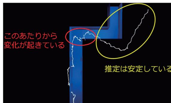
図3 モバイルセンサの自己位置推定
