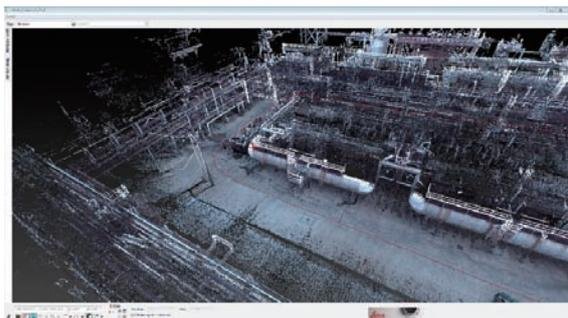
図13 プラント施設熱交換器計測事例2
