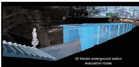
図10 計測データから緊急避難路の策定
