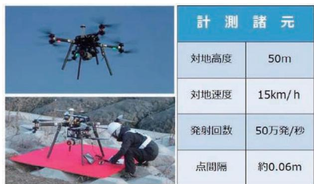
図2.5 計測風景と計測諸元
