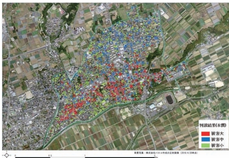
図1 建物被害判読図の例(益城町の一部)
