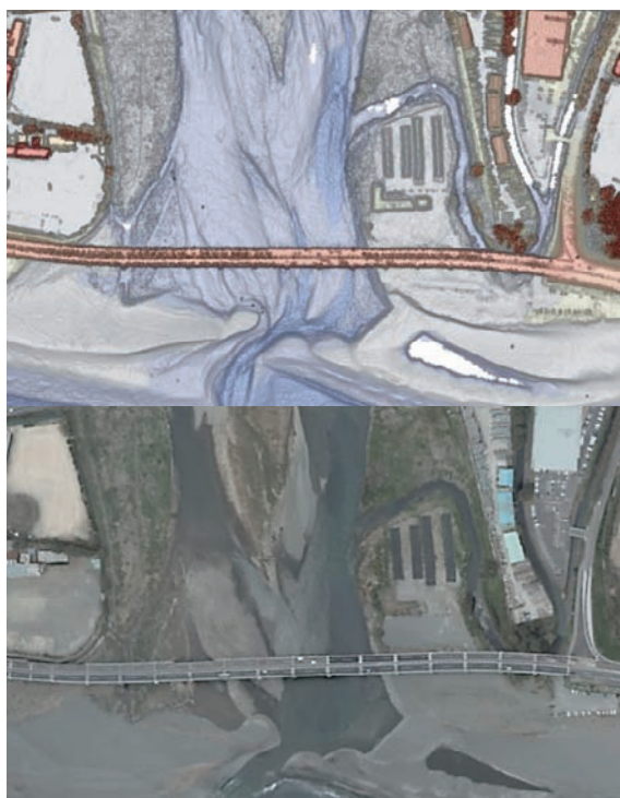
図2 河口部でのALBの計測事例
