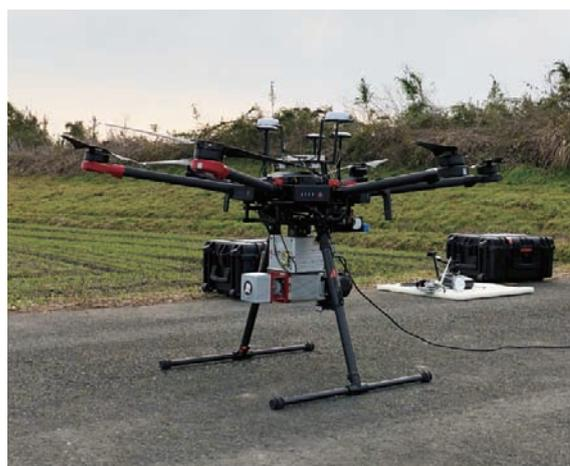
写真1 使用したUAV搭載型レーザ計測システム
