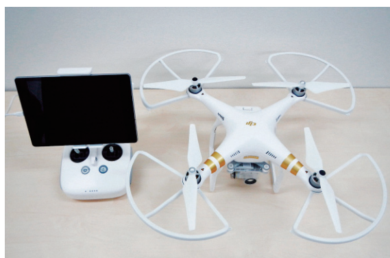
【使用機器】DJI社製 PHANTOM3 【撮影高度】高度100m若しくは150m 【撮影の向き】仰角は任意の角度 【搭載機器】デジタルカメラ 1240万画素(4K対応)
