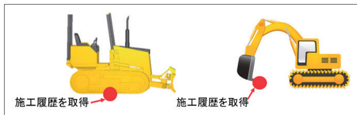
図6.1 施工履歴データ取得箇所
