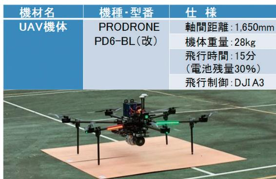
図2 UAVレーザ計測機材及び仕様
