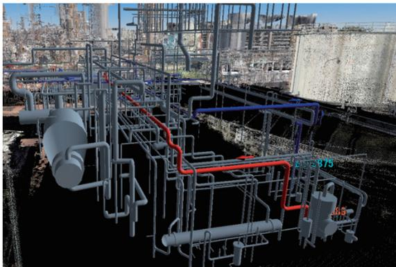
図1 現地配管システムの計測結果
