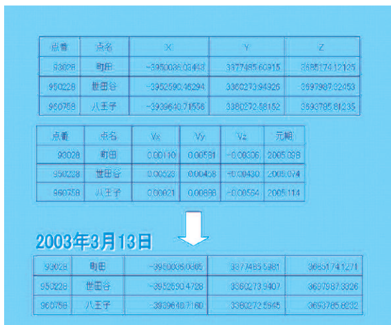
図8 時期化成による座標の計算の例
