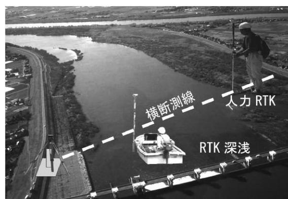
図3 RTK-GPS水部測量イメージ
