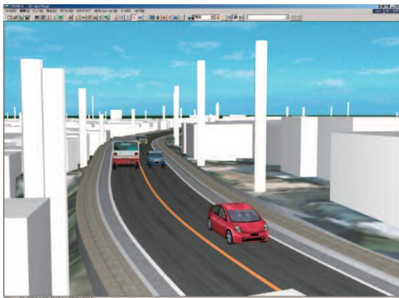
図11 3次元VR 道路シミュレーションモデル その1
