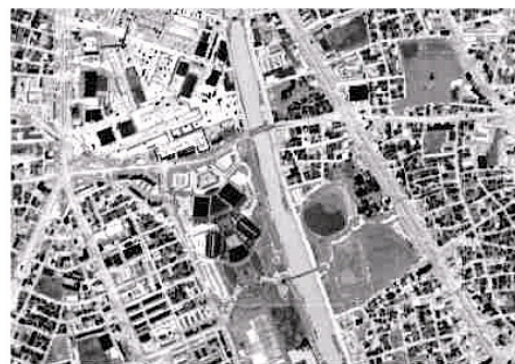
図. 1 航空機MSSによる夜間の熱映像 名古屋市付近 5月20時頃 (明るいほど温度が高い) 上段：解像度5m 下段：解像度2m (一部切出拡大)
