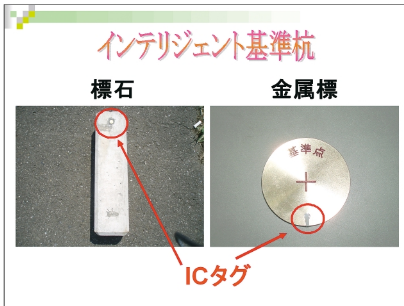
図8 インテリジェント基準点のICタグ
