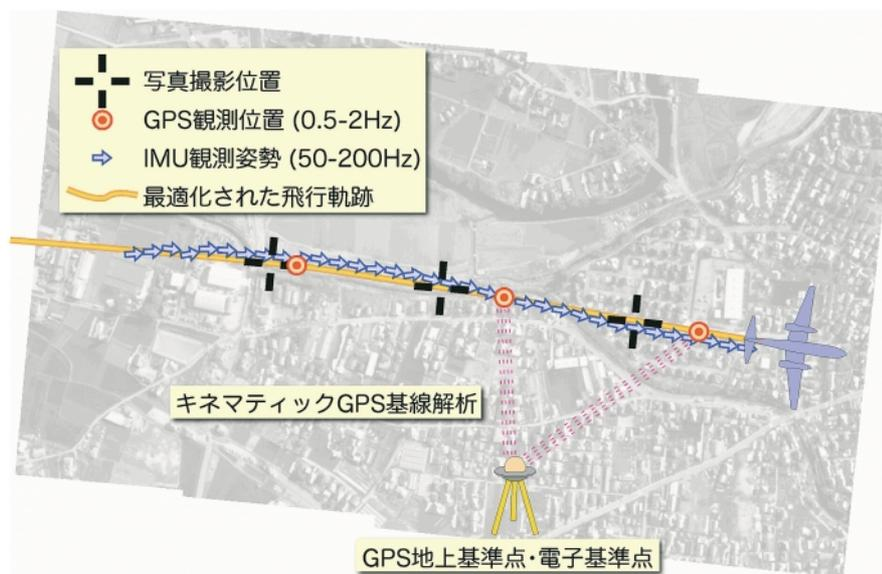
図4 GPS/IMU統合による高精度測位
