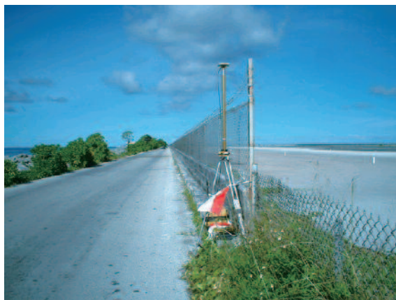
図8 基準点測量（GPS観測MJ1：右・空港滑走路、左・道路 その外側は海）
