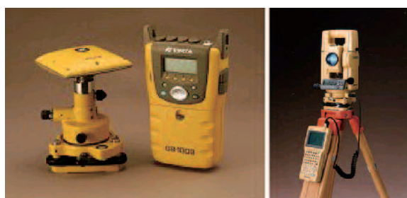
図5 GPS測量機・トプコンGB-1000GD 図6 TS・トプコンGTS-320
