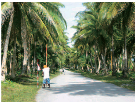
図9 直接水準測量（MJ4～MJ5）
