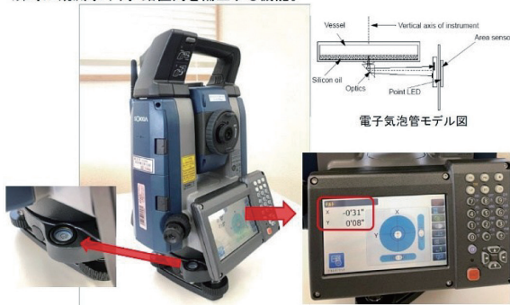
図2 トータルステーションの電子気泡管
